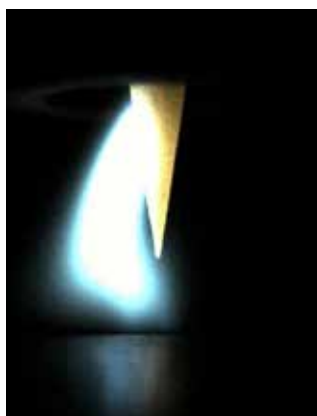
Wolfram nízké kvality: typické zapálení bočního oblouku, který bliká a přibližuje se postupně k hrotu elektrody. Oblouk musí být zhasnut a elektroda uzemněna.
