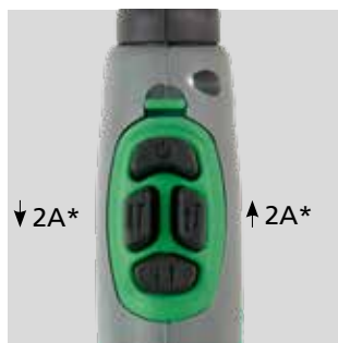
Spínač Up/Down se 4 tlačítky, spínání a nastavování svařovacího proudu, přepínání mezi svařováním a TIG-A Tack. Růst/pokles proudu skokově po 2A. Podržení plynule zvyšujelsnižuje proud. 80300063
