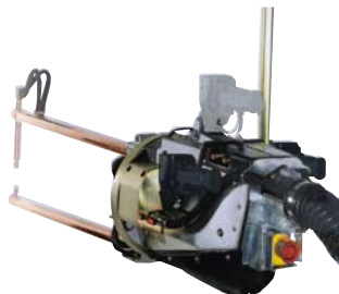
Na přání – navíc držák pro namontování rukojeti na bok stroje a druhá rukojeť s držákem na bok stroje (bez ovládní)
