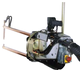
Standard – rukojeť nahoře u řídicí jednotky
