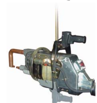
Na přání – navíc držák pro namontování rukojeti na spodní stranu stroje
